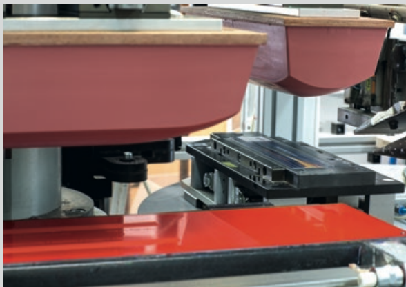
Klischees im Einsatz mit dem Tampondruckverfahren
